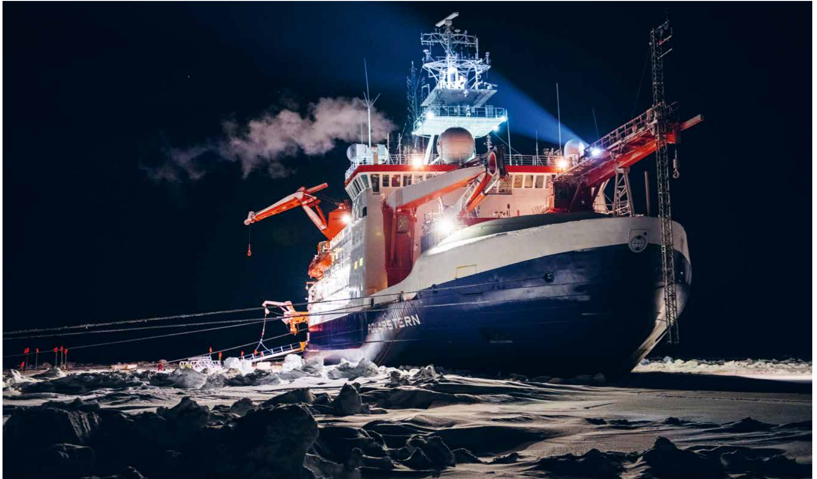
■ Armdicke Seile fesseln den Eisbrecher Polarstern an die Eisscholle. Gemeinsam treiben Schiff und Eis im Mittel 10,7 Kilometer pro Tag.
