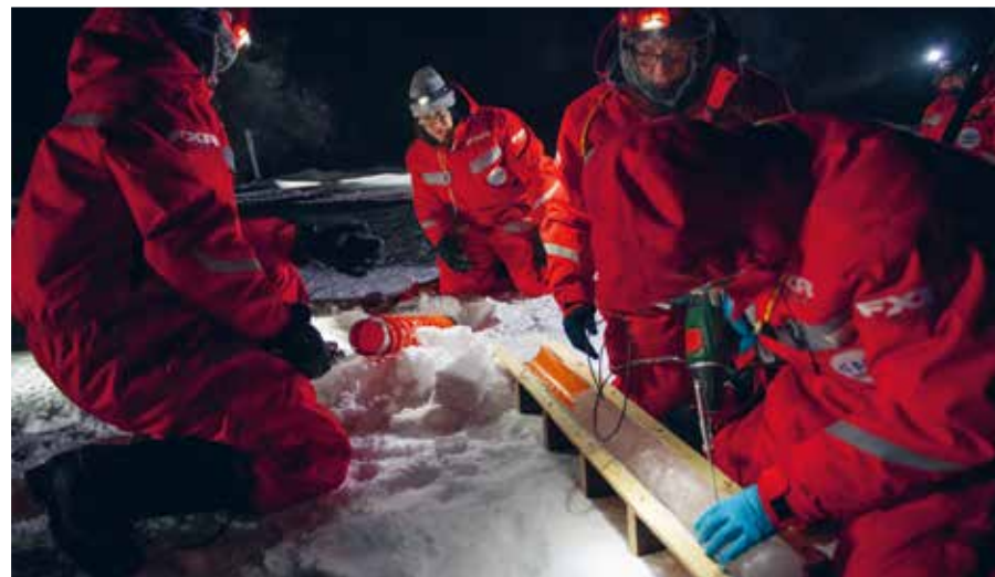
Die Meereisphysiker sind auf der MOSAiC-Expedition nicht die Einzigen, die Eisbohrkerne ziehen. Hier bohren Biogeochemiker ein Loch in einen frisch gewonnenen Kern, um dessen Temperatur zu messen.
